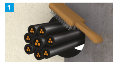
Oczyścić wejście do otworu i jeśli to konieczne, usunąć przewody z przejścia.
