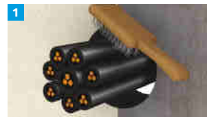
1 Oczyścić wejście do otworu i jeśli to konieczne, usunąć przewody z przejścia.
