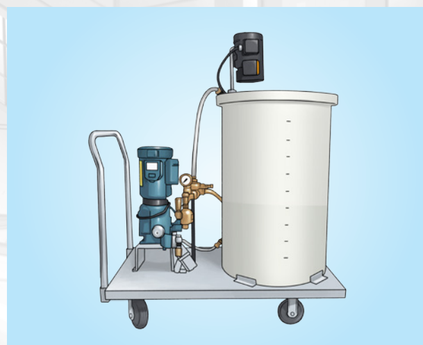
Plastikowy zbiornik, mieszarki i pompa o regulowanym przepływie z węzami dolotowymi i wylotowymi, które doprowadzają roztwór do głowicy pistoletu natryskującego.
